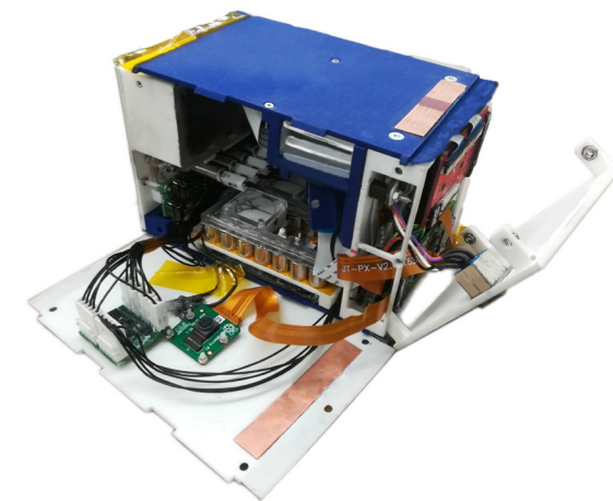
Zusammenbau des PAPELL-Flugexperiments. Quelle: KSat e.V.
