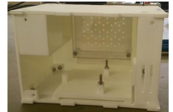
3D-gedruckte Struktur des PAPELL-Experiments.
