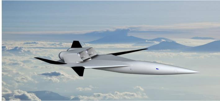
Das revolutionärste an diesem Entwurf ist sicher der Verzicht auf die Mitnahme eines Fahrwerks, was eine drastische Verringerung der Strukturmasse und des maximal erforderlichen Schubs erlaubt. Das wird durch den Einsatz eines bodenbasierten Fahrwerkssystems, das das Flugzeug beim Start beschleunigt und es bei der Landung automatisch wieder abfängt.
