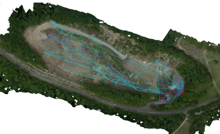
Abb. 2: Lokales Netz mit Instrumentenstandpunkten
