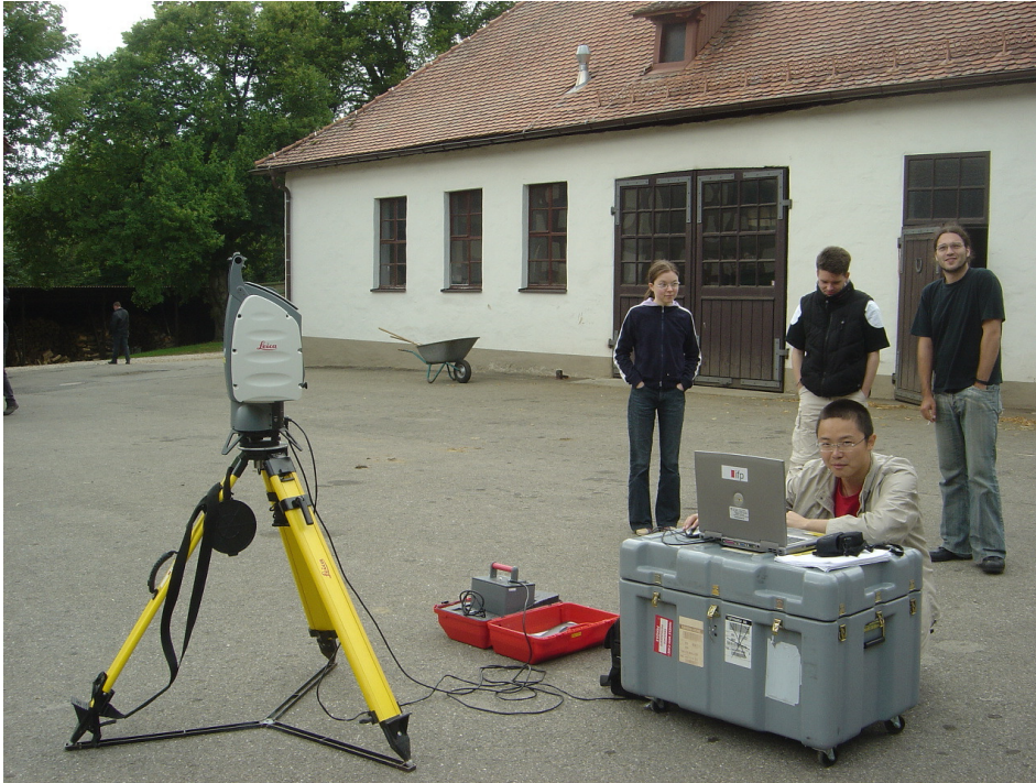
Abb. 14: Aufbau des Laserscanners HDS3000
